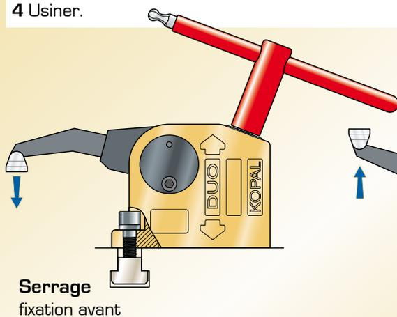
Fixation sur table à rainures avec vis spéciale M10
